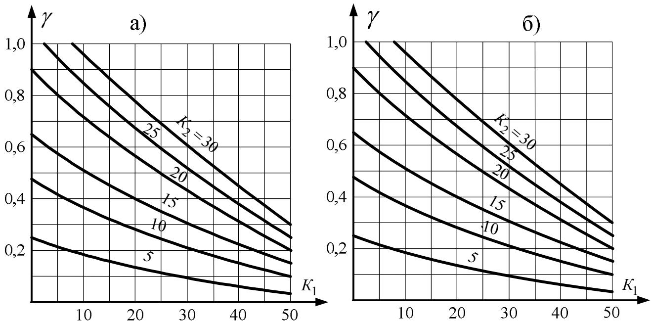
Рисунок 3.1 – Значения коэффициента  $\gamma$  для радиальной схемы питания трансформаторов, а) напряжение – 6 кВ, б) напряжение - 10 кВ
